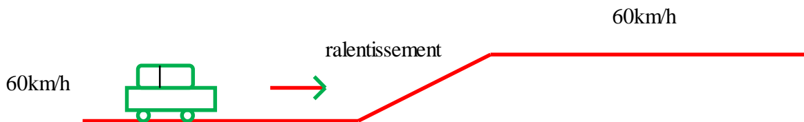
Figure 1.24 : exemple de régulation (rejet de perturbation).
