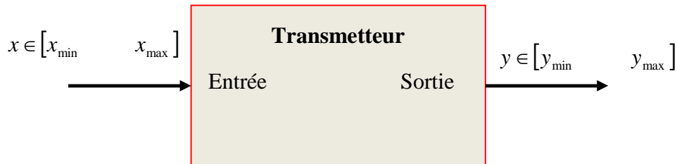
Figure 1.15 : Entrées- sorties d'un transmetteur.
