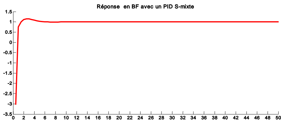
Figure 3.10: Réponse du système boucle fermée avec PID série.
