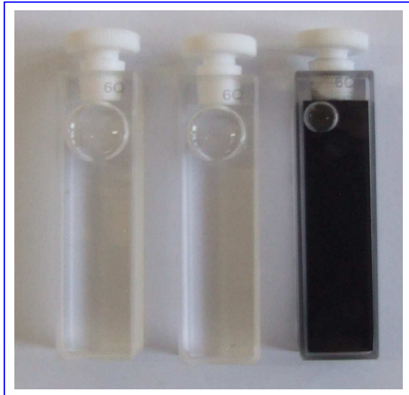
Figure V.25: Echantillon de \text{CuIn}_{1-x}\text{Ga}_x\text{Se}_2 préparé en solution pour analyse par spectrophotomètre. En blanc la solution de référence et en noir l'échantillon de \text{CuIn}_{1-x}\text{Ga}_x\text{Se}_2 en solution.
