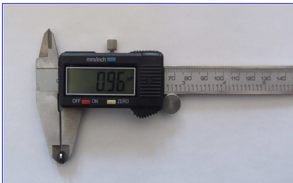
Figure V.30: Mesure de l'épaisseur des pastilles de \text{CuIn}_{1-x}\text{Ga}_x\text{Se}_2 .
