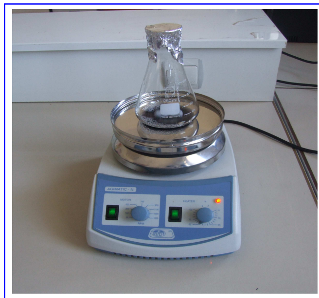
Figure V.24 : Dilution de l'échantillon de \text{CuIn}_{1-x}\text{Ga}_x\text{Se}_2 en solution à l'aide d'un agitateur magnétique avec plaque chauffante.
