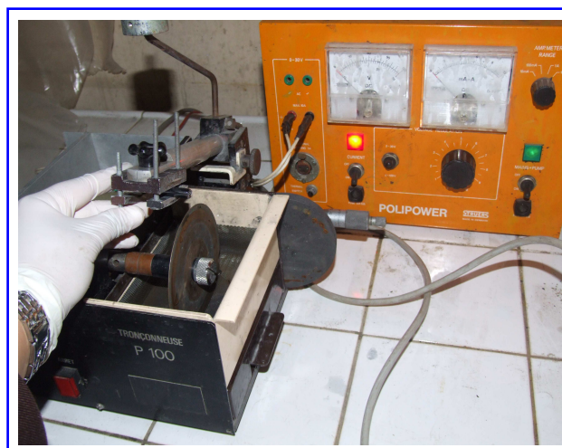
Figure V.1 : Tronçonneuse utilisée pour la découpe des lingots de \text{CuIn}_{1-x}\text{Ga}_x\text{Se}_2 .
