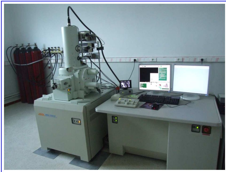
Figure V.20: Analyse des lingots de \text{CuIn}_{1-x}\text{Ga}_x\text{Se}_2 par microscope électronique à balayage.
