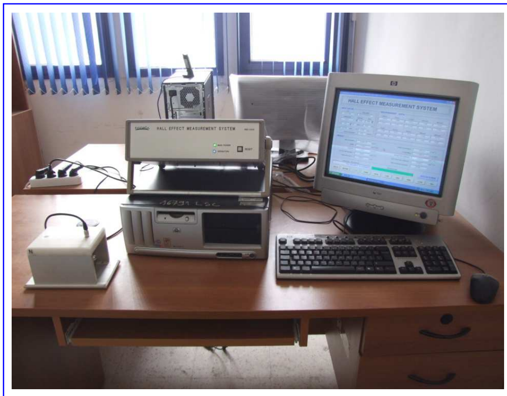
Figure V.29: Détermination des propriétés électriques des échantillons de \text{CuIn}_{1-x}\text{Ga}_x\text{Se}_2 par mesure d'effet Hall.
