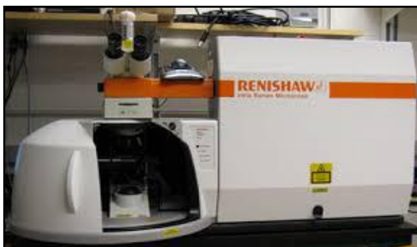
Figure III. 5. Dispositif expérimental de la rétrodiffusion ( \mu -Raman) utilisé [22]
