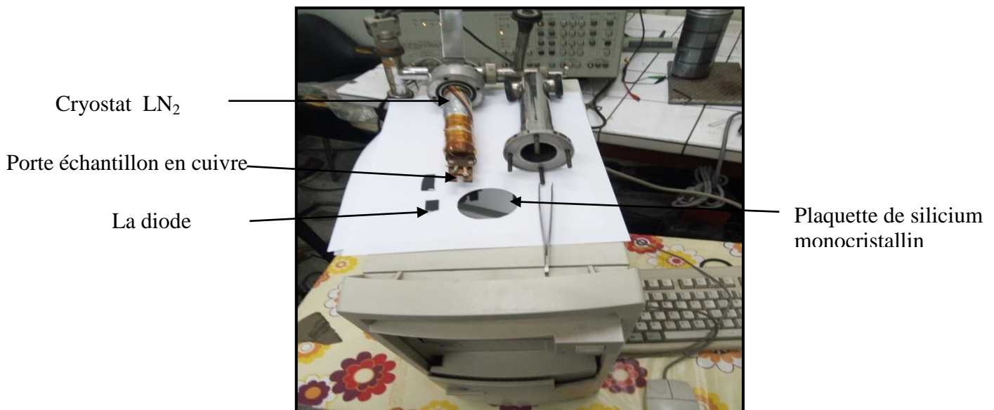
Figure III. 8. Placement de la diode dans le cryostat.
