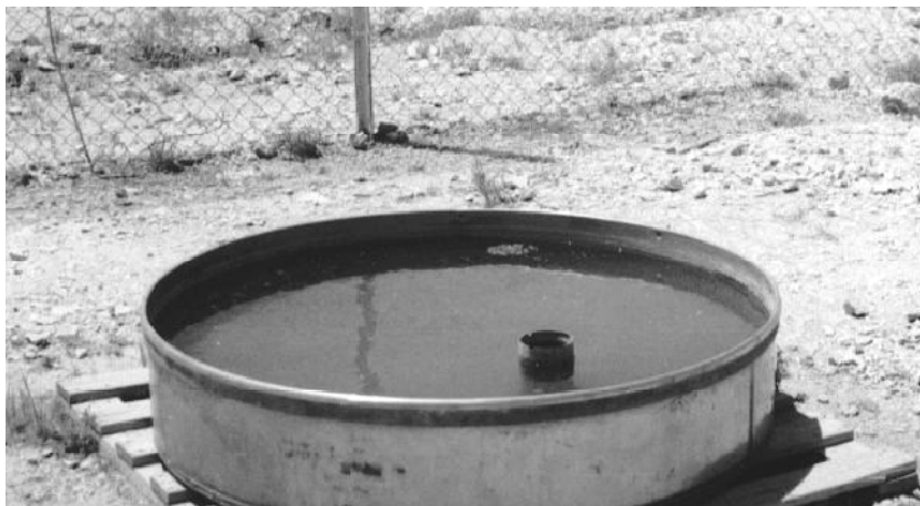
Figure 24 : Photographie d'un Bac de Colorado installé à proximité de la retenue du barrage de Foum El Khanga sur l'Oued Cherf.
