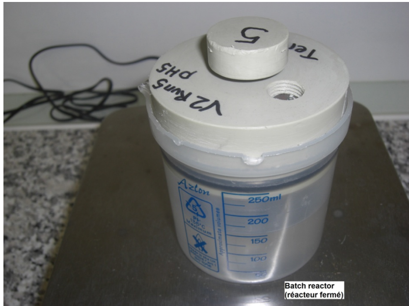
Figure 96 : Photographie d'un réacteur fermé utilisé dans nos manip.
