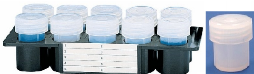
Figure 29 : Flacons Savillex utilisés lors des attaques acides des sols.
