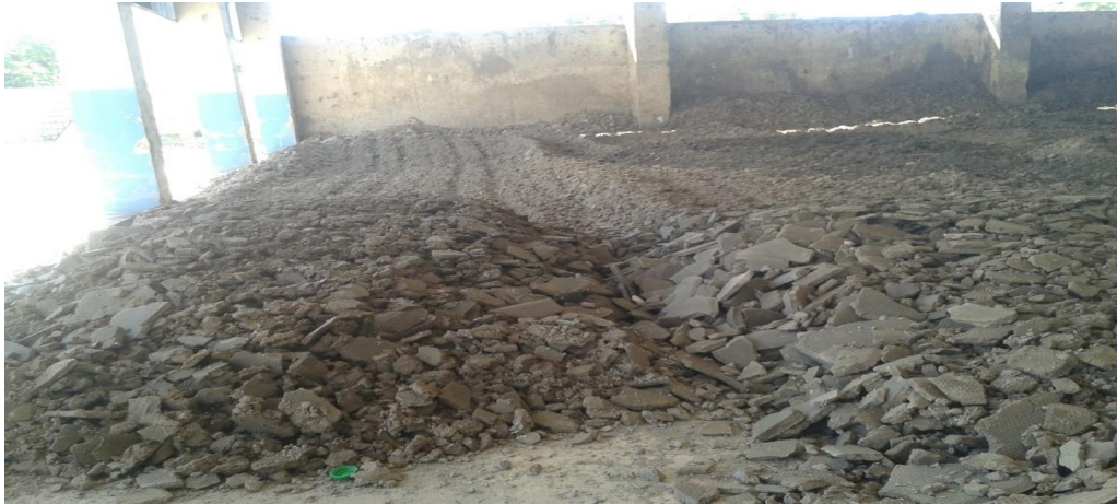
Figure n°24. Stockage de boues au sol (Station d'El-Allélick, Annaba).
