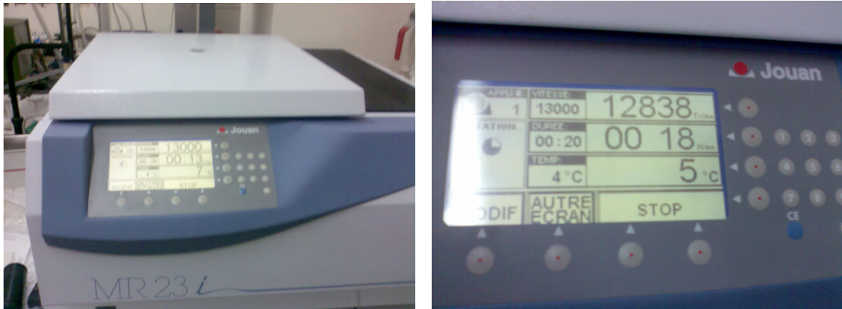
Figure III-3 : Photographie d'une Centrifugeuse de marque Jouan MR23i : La photo de droite exhibe l'écran de la centrifugeuse par l'intermédiaire duquel on arrête les paramètres de la centrifugation (vitesse, température et durée principalement)
