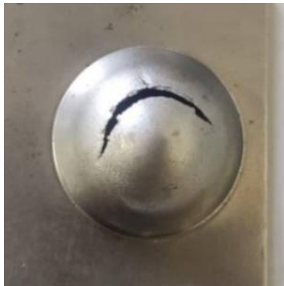
Figure III.10 : Méthode de mesure de la profondeur de déformation de la cupule : a) avant ECAP ; b) après ECAP.
