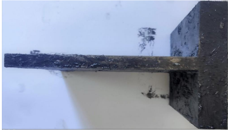
Figure II.5 : Poinçon utiliser dans l'ecap.
