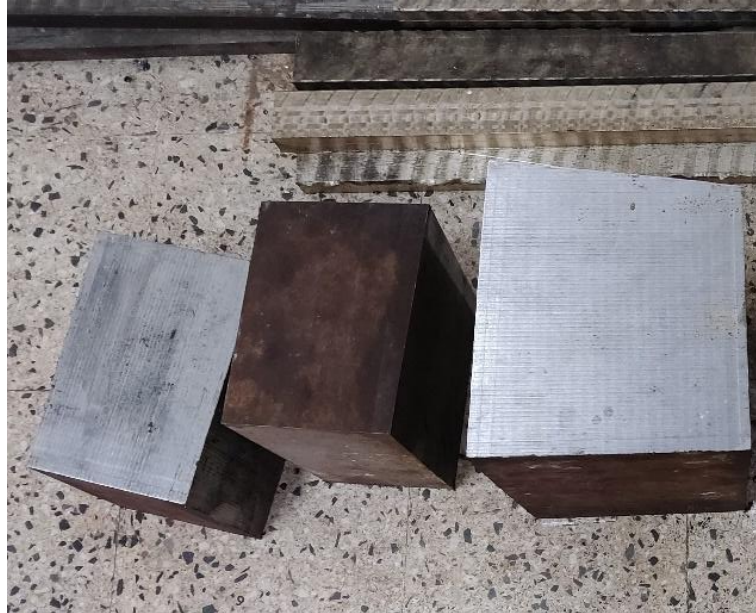
Figure II.2 : bloc de 55NCDV5 utilisé
