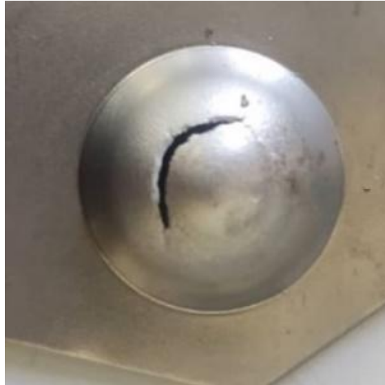
Figure III.11 : Fissuration de la plaque après le test d'Erichsen : a) avant ECAP ; b) après ECAP
