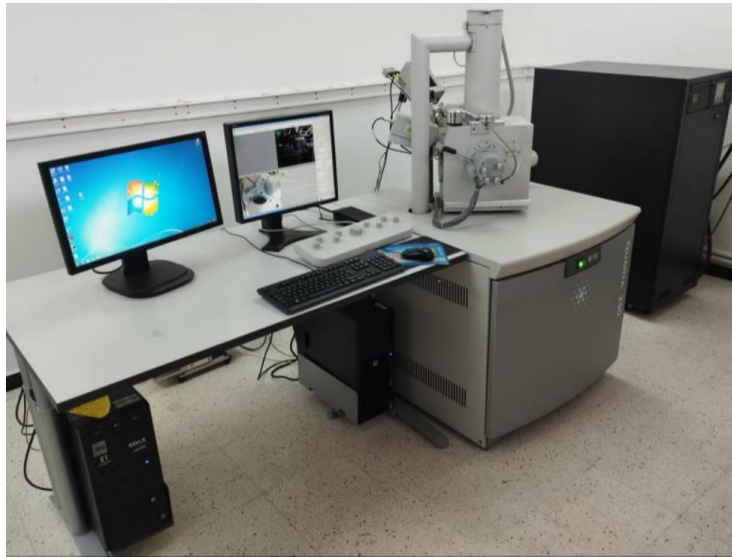
Figure II.21 : Microscope électronique à balayage, modèle Quanta 250
