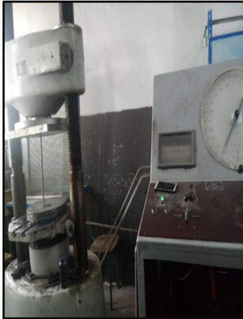
Figure II.6 : La presse hydraulique UMM-10 utiliser et sa commande
