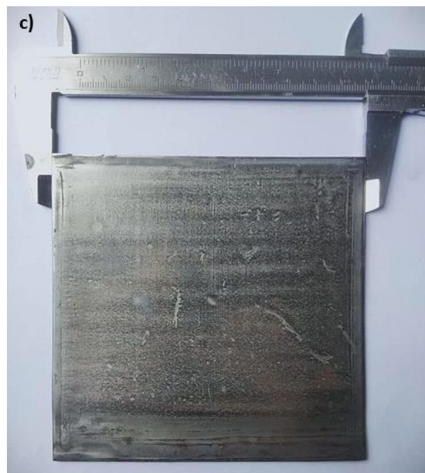
Figure II.8 : Tôle d'acier DC04 a) avant ECAP, b) S1 après ECAP (120°), c) S1 après ECAP (90°).
