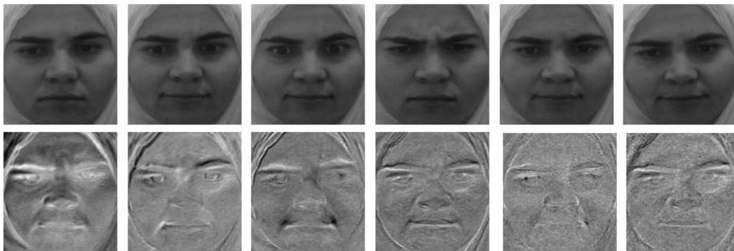
Figure 2.9 Exemple de calcul d'Eigenfaces: La première ligne présente des images de visage avec quelques expressions faciales et la deuxième visualise les eigenfaces correspondants [MAA 12].
