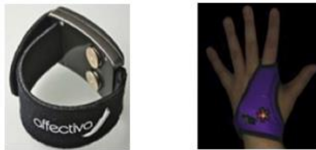
Figure 1.16 Exemple de capteurs de la conductivité de la peau (a) et (b) représentent respectivement un bracelet et un gant utilisés pour mesurer la réponse galvanique de la peau [JRA 13].
