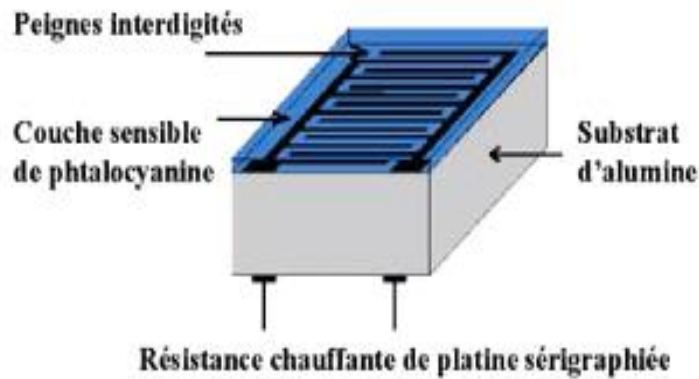
Figure 3.2. Schéma du capteur de gaz à base de couche mince de phtalocyanine de cuivre (3 x 5 mm).
