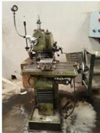
Fig.3: Fraiseuse verticale pour l'usinage des éprouvettes.
