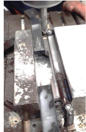
Fig.2.9: Usinage de l'éprouvette.
