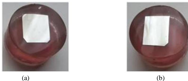
Fig.2.1: Les échantillons après enrobage, polissage et attaque chimique de surface.
