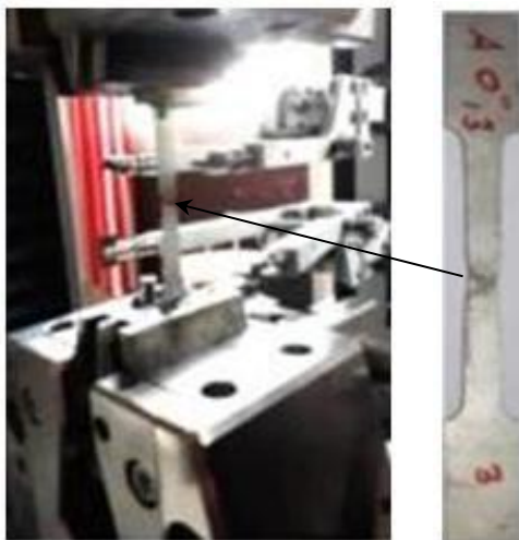
Fig.2.12: Eprouvettes [A0°,3] à ( v=50 mm/min)
