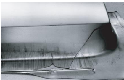
Fig.4.19: Rupture due au grippage.
