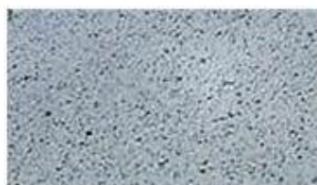
Fig.1.21 : Motif aléatoire réalisé sur une éprouvette.
