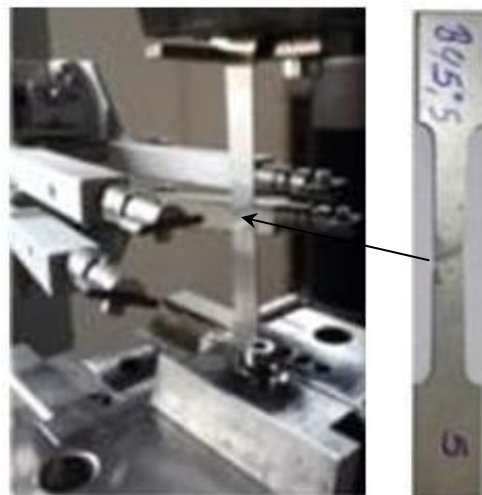
Fig.2.13: Eprouvettes [B45°,5] à ( v=100 mm/min)
