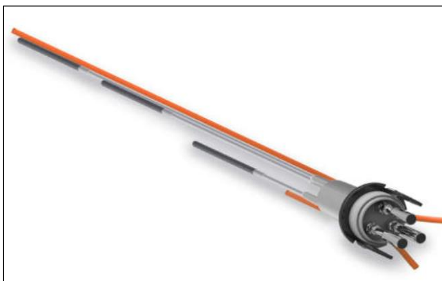
Figure IV.2 Extensomètre en forage multipoints de type MPBX
