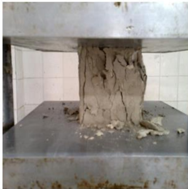
FIGURE II.17 Propagation de la fissuration dans le béton
