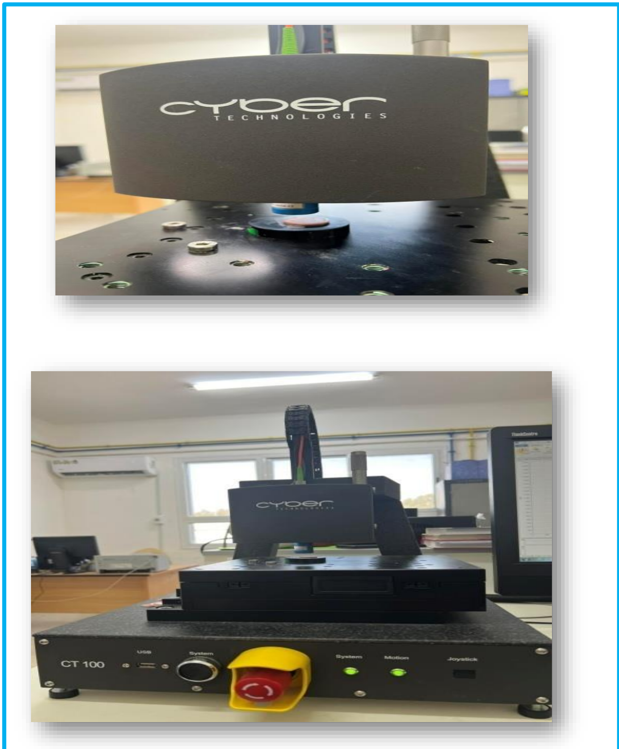
Figure 34: Rugosimètre optique 3D type CT-100. N. Mohamed Ben Ali (Laboratoire de recherche Badji Mokhtar Annaba) (Labo De Recherche : Santé Bucco-Dentaire).
