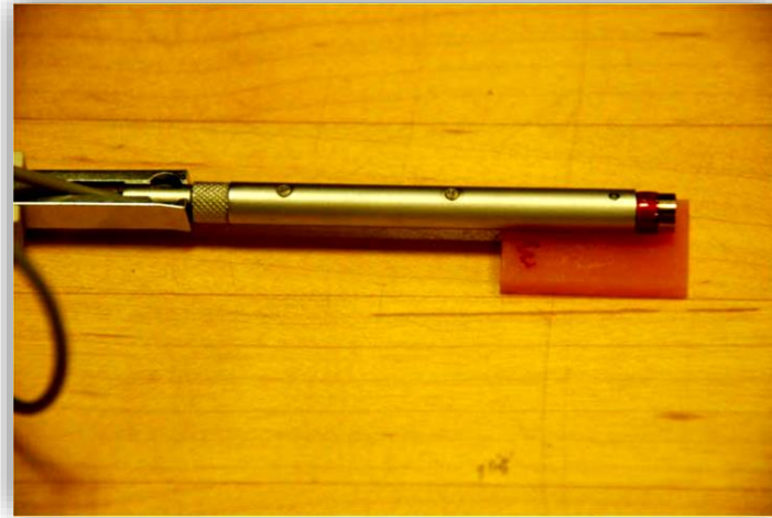
Figure 16: Enregistrement de la rugosité d'une résine acrylique par un profilomètre [120].
