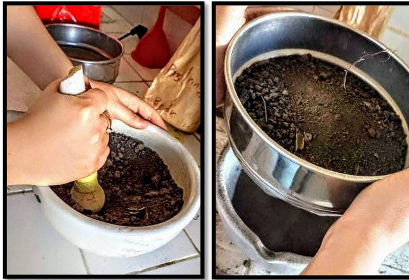
Figure 24 : Protocole de préparation des échantillons de sol. (Cliché Benotmane K, 2021)
