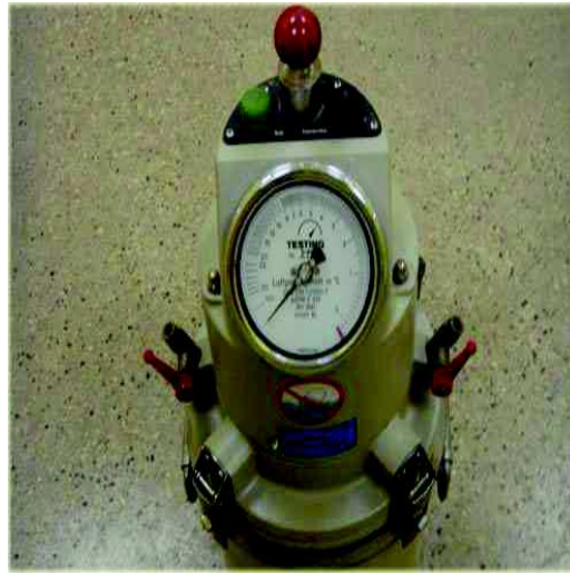
Figure II.21. Dispositif de mesure de la teneur en air occlus.
