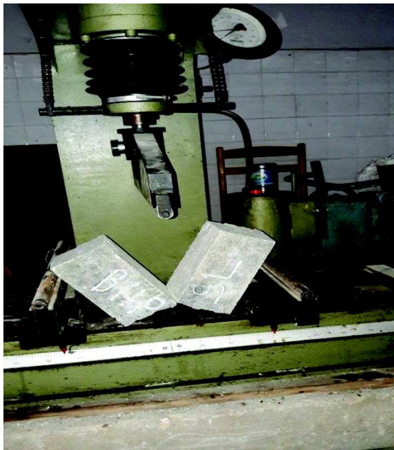
Figure III.2. Description de l'essai de traction par flexion (LMGE Université de Annaba).
