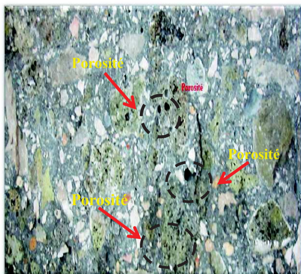
Figure III.16. Analyse macrostructural des BHP à base de granulats de laitier cristallisé.
