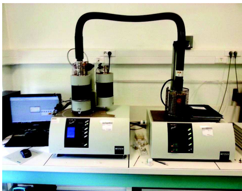
Figure IV.16. Dispositif utilisé pour l'analyse thermogravimétrique (LMDC-INSA Toulouse).
