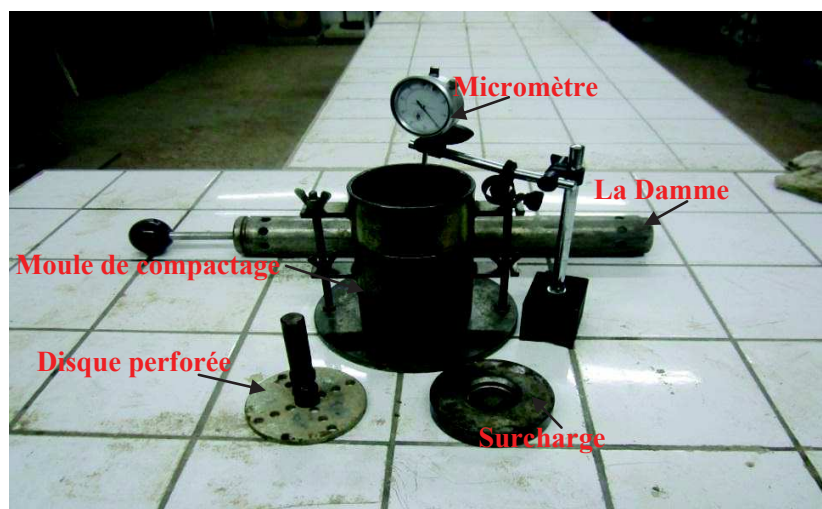
Figure II.17. Moule de compactage pour l'essai de l'autoclave.
