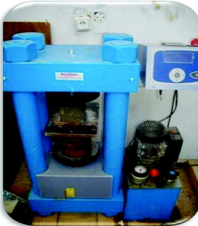
Figure III.1. Description de l'essai de compression (LMGE Université de Annaba).
