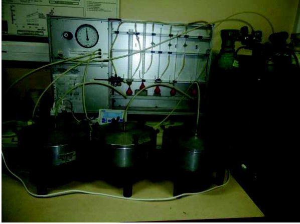
Figure IV.3. principe de dispositif du perméamètre CEMBUREAU.
