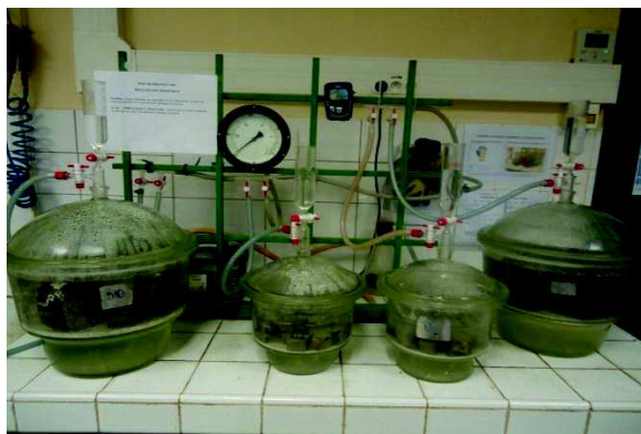
a- Dessiccateurs à vide pour le dégazage des échantillons
