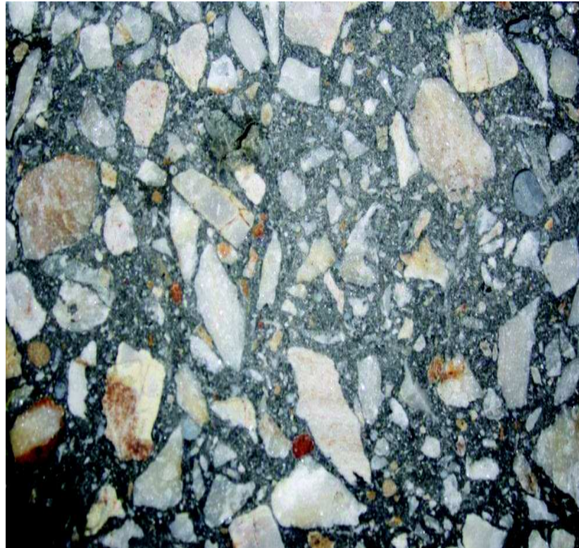
Figure III.18. Analyse macro structural des BHP à base de granulats de calcaire pur blanc.
