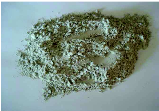
Figure II.2. Filler de laitier granulé
