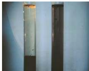
Figure V-14 : Test de décantation : présence de flottants (STEP de Souk-Ahras)
