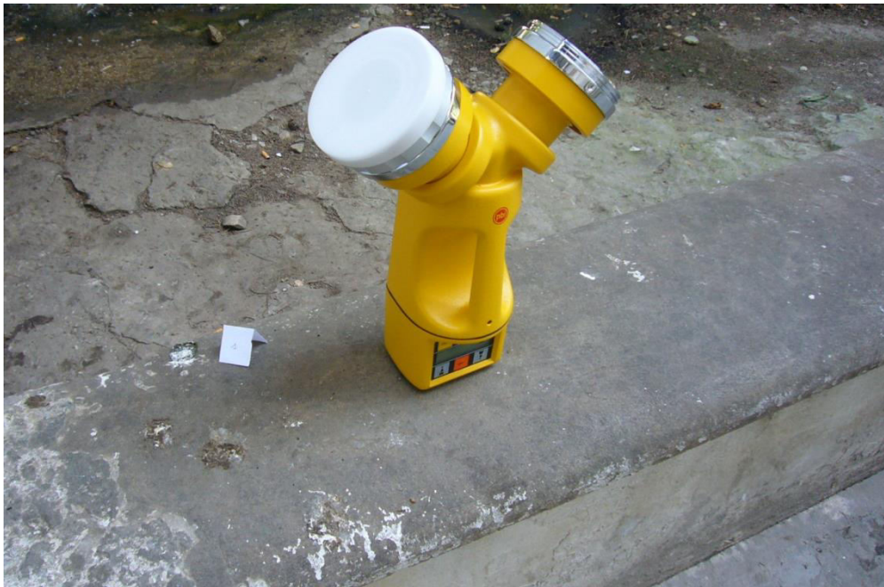
Figure n°12: prélèvement de l'air atmosphérique par l'appareil SAS AIR SAMPLER Duo 360.
