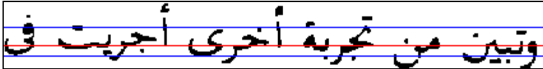
Figure 4. 22. Ligne de base et zone médiane détectées sur une ligne de texte
