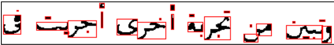
Figure 4. 21. Ligne de texte segmentée en composantes connexes
