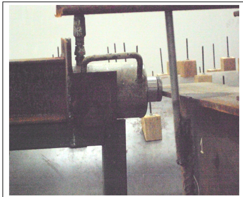
Fig.4.7 Détail d'application de la charge horizontale
