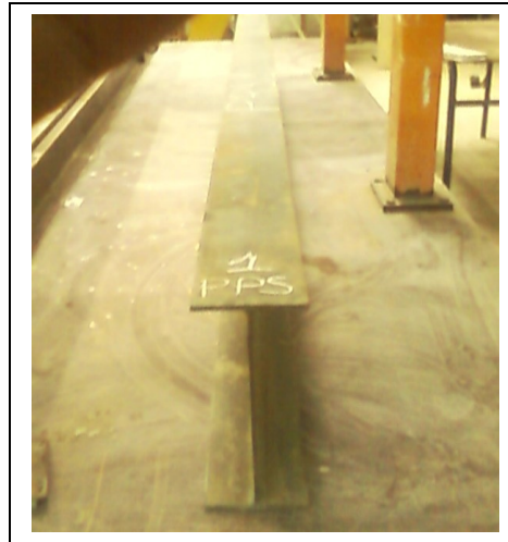
Fig.4.2 La poutre PRS
