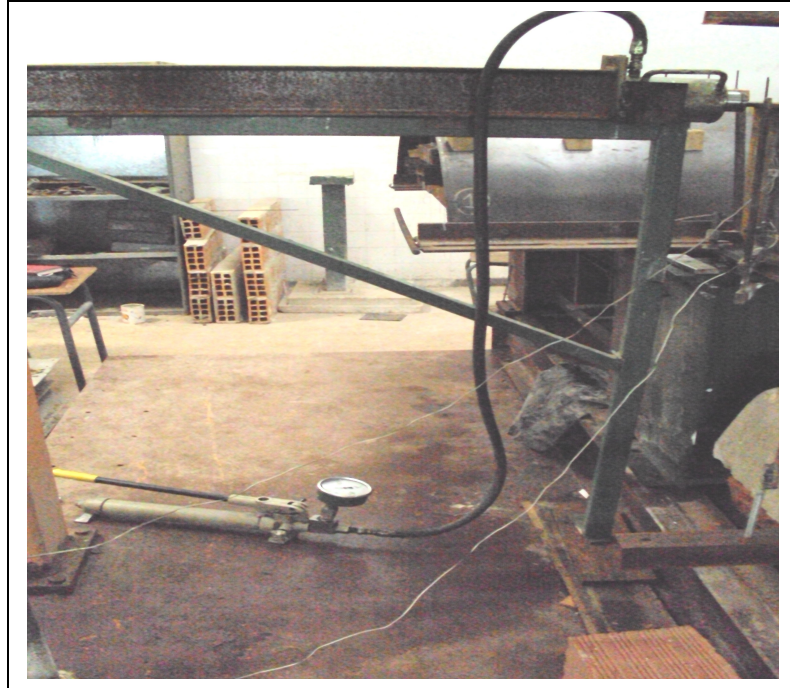
Fig.4.6 Système d'application de la charge horizontale
