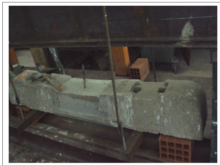
Fig.4.5 Système d'application de la charge uniforme
