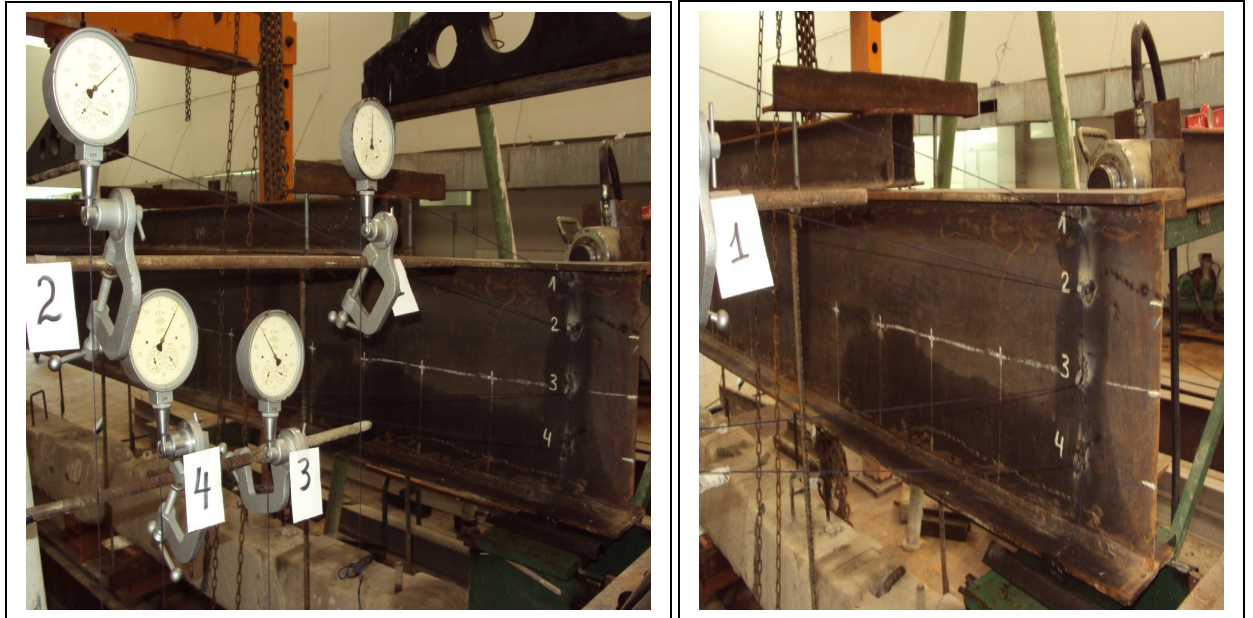
Fig.4.10 Compérateurs des déplacements positionnés à l'extrémité de l'âme
