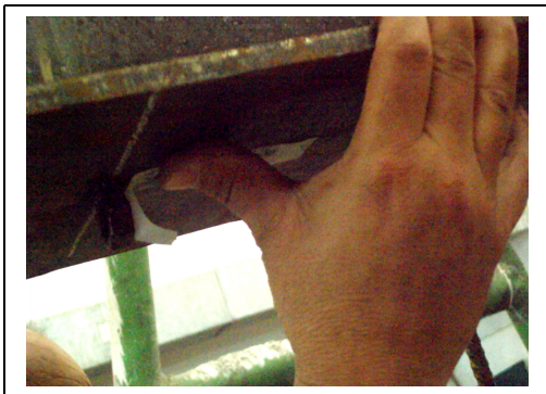
Fig.4.9 Différentes étapes de placement des jauges de déformations
