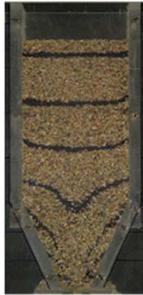
Figure 4.9. Technique des couches colorées. [54].
