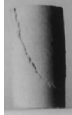
Figure 3.2. Une surface de rupture dans un échantillon cylindrique de l'argile. [15].
