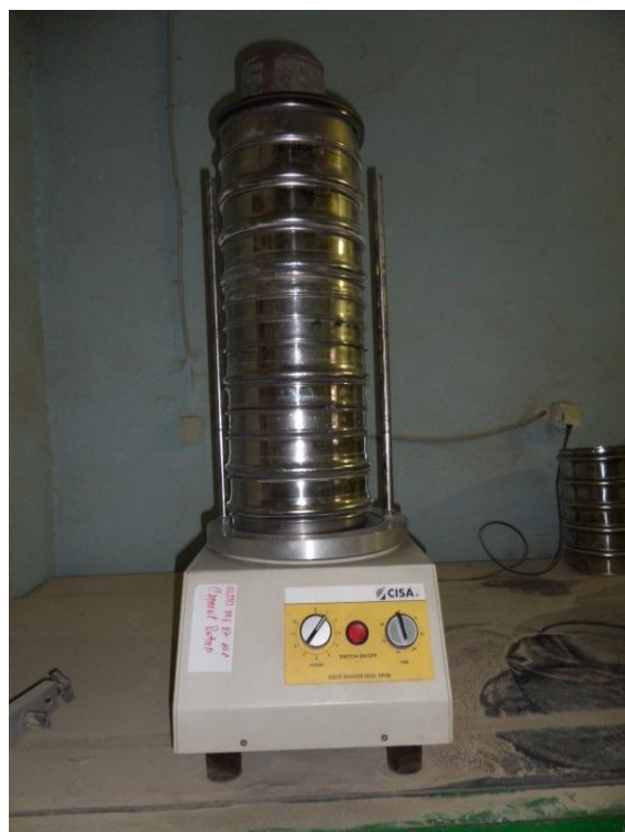
Figure 27 - Tamiseuse utilisé pour l'analyse granulométrique au niveau de laboratoire du complexe de Djebel Onk – Tébessa
