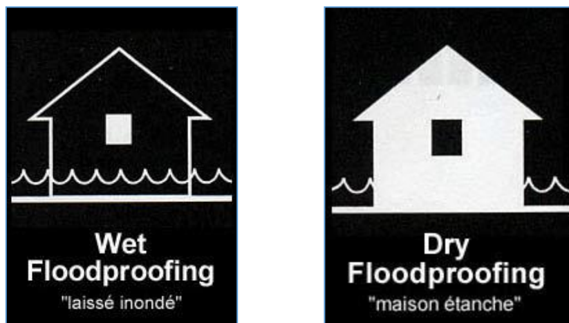
Figure 32. Adaptation de l’aménagement de l’habitat à l’inondation. Source : www.essonne.fr
