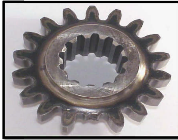
Figure. I.24. Photo du pignon droit examinée dans un appareillage de puissance-circulation d'essai de fatigue d'engrenage jusqu'à la rupture de dent.
