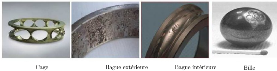
Figure 1.25: Défaut d'écaillage réel
