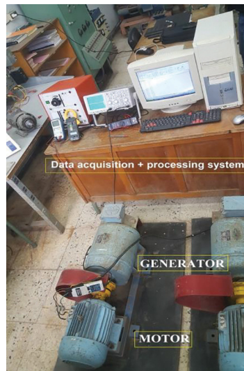
Figure 5.1: Configuration expérimentale pour la détection de défauts combinés
