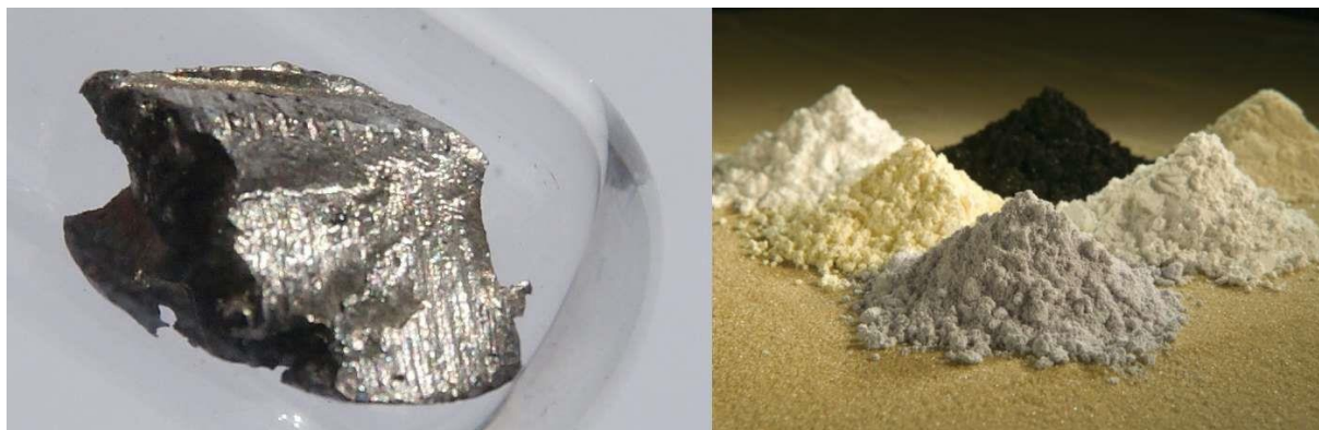
Figure II.2 : Images du cérium, un métal argenté malléable (image de gauche), et sous forme oxydée (image de droite/ le cérium est le dernier élément à droite).
