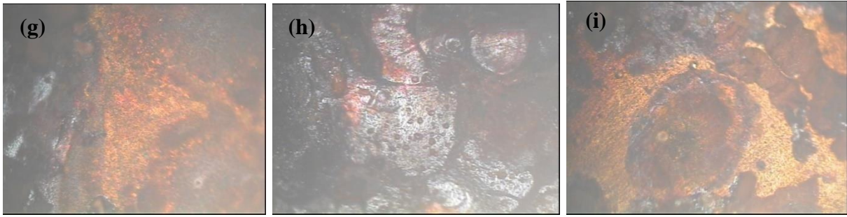
Figure IV.33 : Images de l'acier, prises par microscope optique, dans 0,1M NaCl en présence de (Ce + PEG), en fonction du temps d'immersion : (a) : 30 min ; (b) : 1 jour ; (c) : 2 jours ; (d) : 3 jours ; (e) : 5 jours ; (f) : 10 jours ; (g) : 20 jours ; (h et i) : 30 jours.
