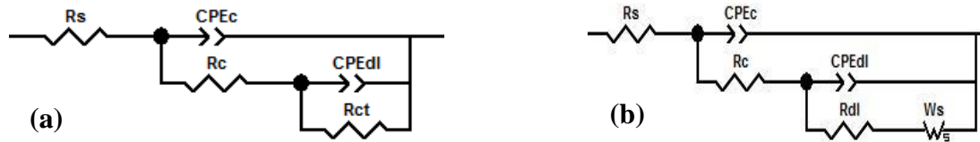
Figure IV.9 : Schéma électrique équivalent, utilisé pour modéliser les diagrammes d'impédance électrochimiques, obtenus pour l'acier immergé à différentes concentrations de NaCl ; (a) pour 0,1 et 0,5M, et (b) pour 1M.
