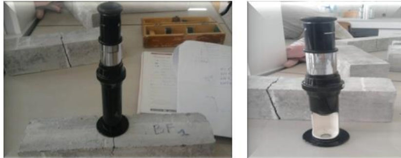
Figure 7.2. Mesure d'ouverture à l'aide d'un fissuromètre.
