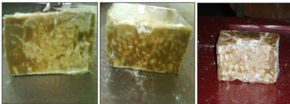
Figure 3.32. Mode de rupture des éprouvettes en compression.
