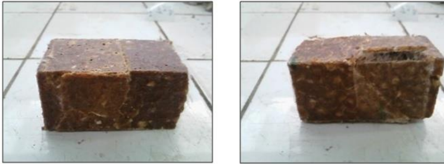
Figure 3.45. Mode de rupture des éprouvettes en compression de béton de résine fibré.
