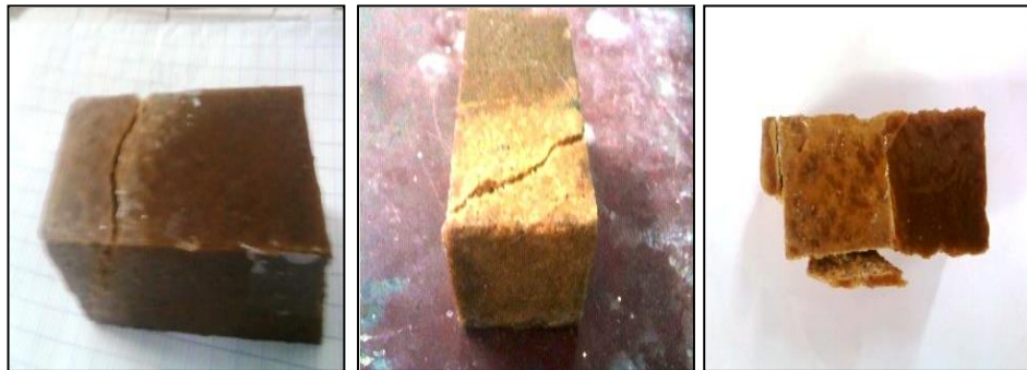
Figure 3.22. Mode de rupture des éprouvettes en compression.
