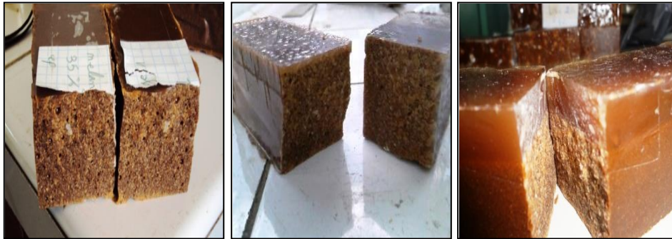
Figure 3.21. Mode de rupture des éprouvettes en flexion.
