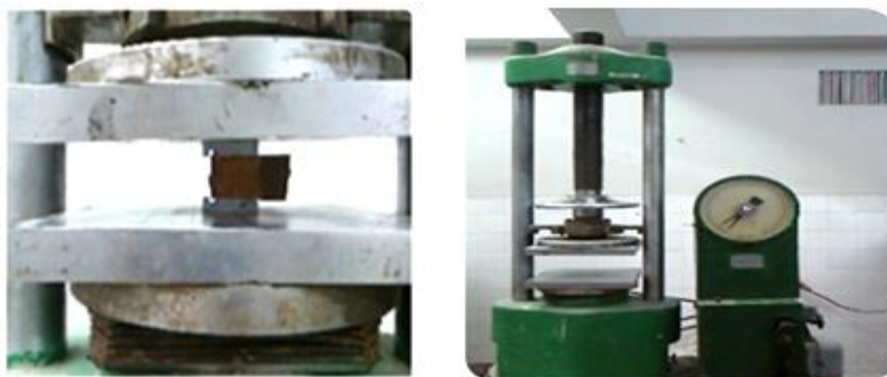
Figure 2.13. Dispositif d'essai de compression sur un béton de résine.
