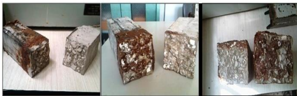
Figure 7.13. Mode de rupture des éprouvettes en flexion après la réparation.
