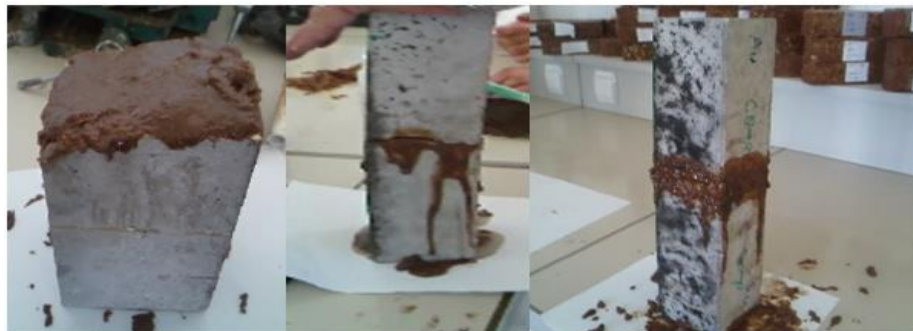
Figure 7.8. Réparation avec le mortier de résine polyester (sans bandage).
