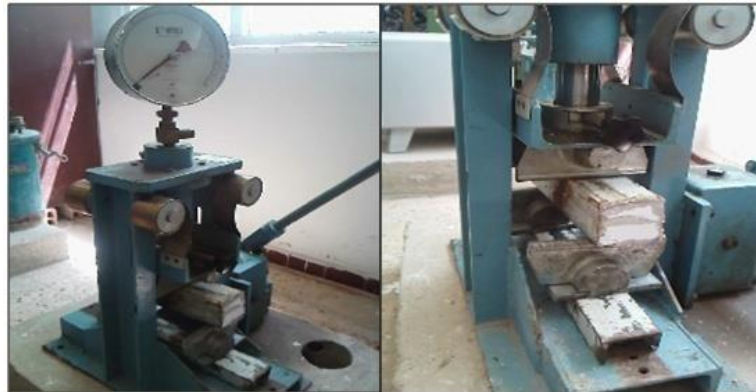
Figure 7.11. Dispositif d'essai de traction par flexion 4 points.
