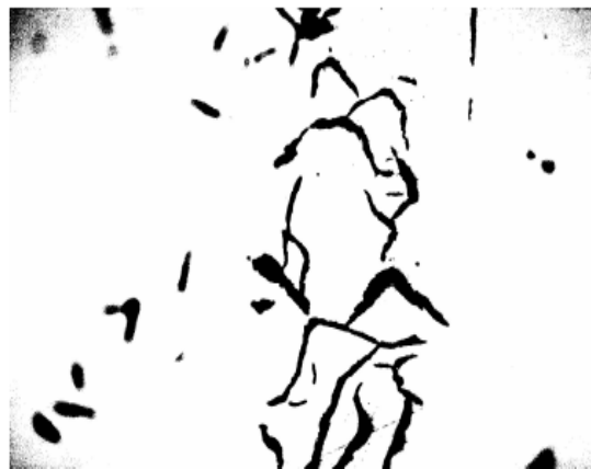
Figure n° 3 – Lamelles de graphite enchevêtrées G= 750X
