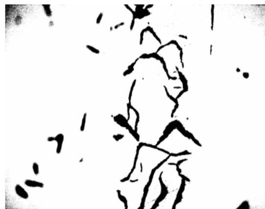
Figure n° 3 – Lamelles de graphite enchevêtrées G= 750X
