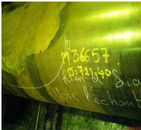
Fig.3 : photos de quelques cylindres écaillés
