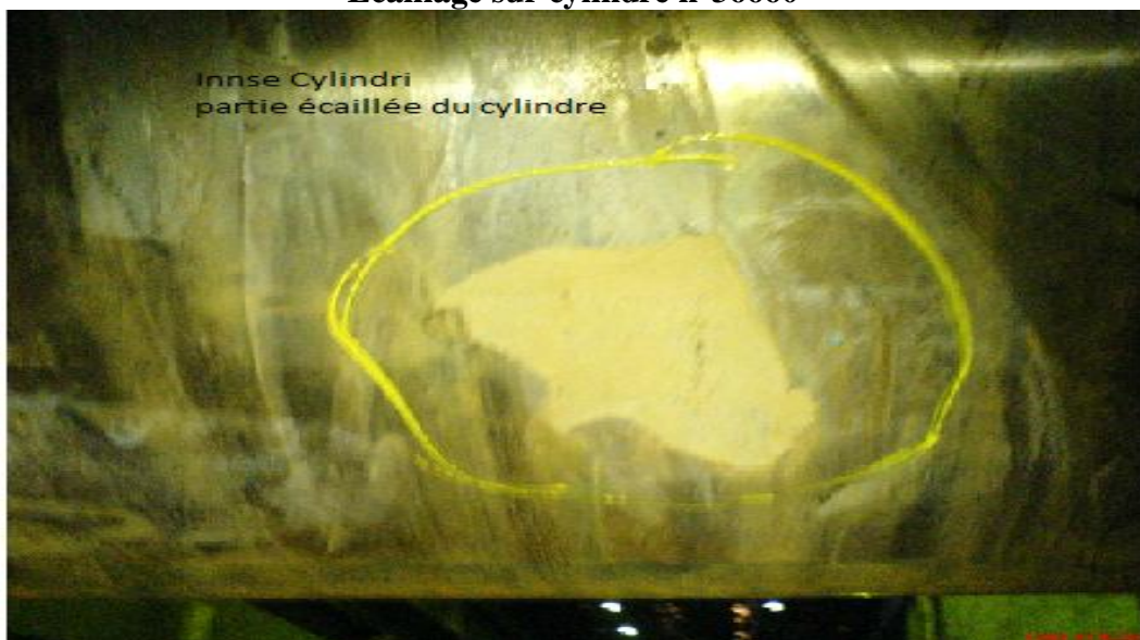
Fig.21: photographie du cylindre écaillé INNSE Cylindri.
