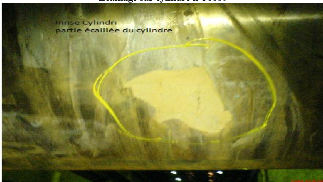
Fig.21: photographie du cylindre écaillé INNSE Cylindri.
