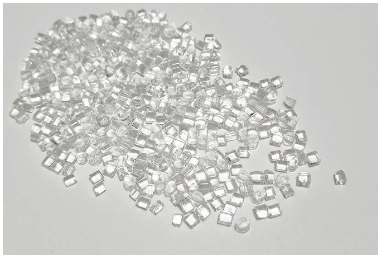
Figure 17: Granulés de polyamide-12 (PA-12) sous forme brute. (20)
