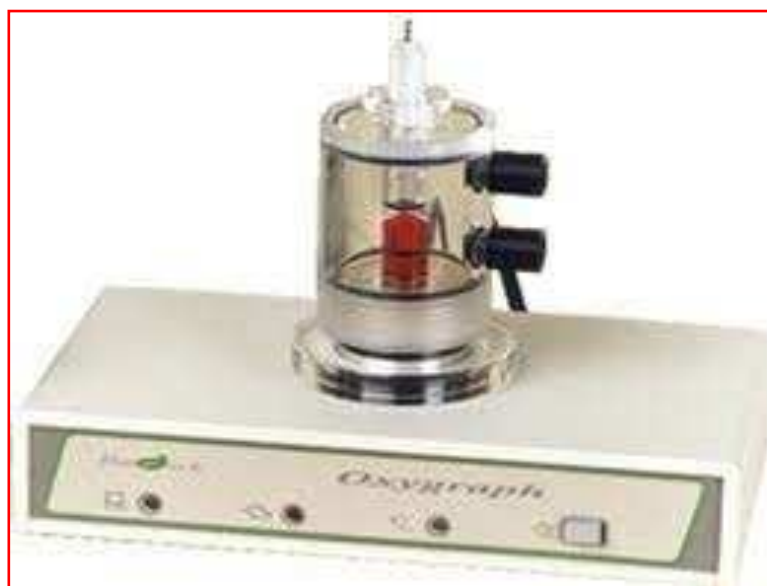
Figure 15 : Oxygraphe à électrode d'oxygène «Hansatech Instruments»
