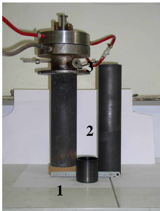
Figure (III.2) : Photographie et schéma général de la cellule de travail : (1) creuset en carbone vitreux, (2) creuset de garde en graphite, (3) couvercle en graphite, (4) sas d'introduction des solutés et des électrodes de travail, (5) amenées de courant avec des électrodes, (6) tête de la cellule avec système de refroidissement à eau.
