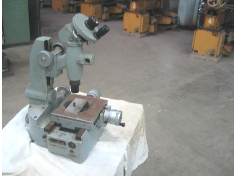
Figure II.5 :Microscope pour la mesure de l'usure.*
