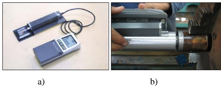
Figure II.7 :Mesure de topographie in situ avec le rugosimètre portable Mitutoyo.
