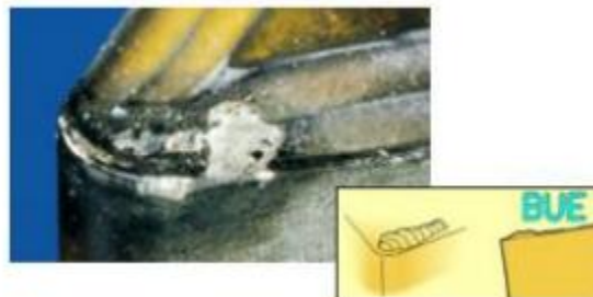
Figure I.22 : Usure par arête rapportée
