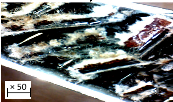
Figure II.23. Cisaillement des parois de l'âme
