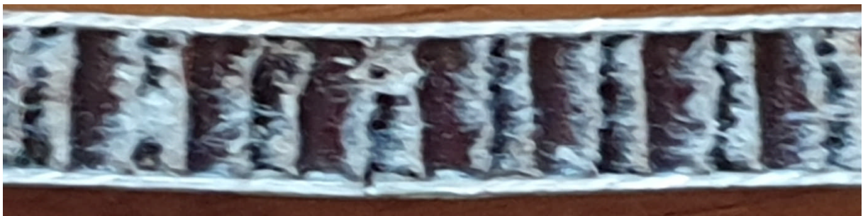
Figure II.29. Légère indentation des peaux.
