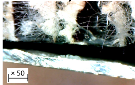
Figure II.24. Décollement de l'âme
