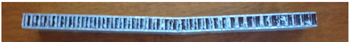
Figure II.22. Légère indentation des peaux.
