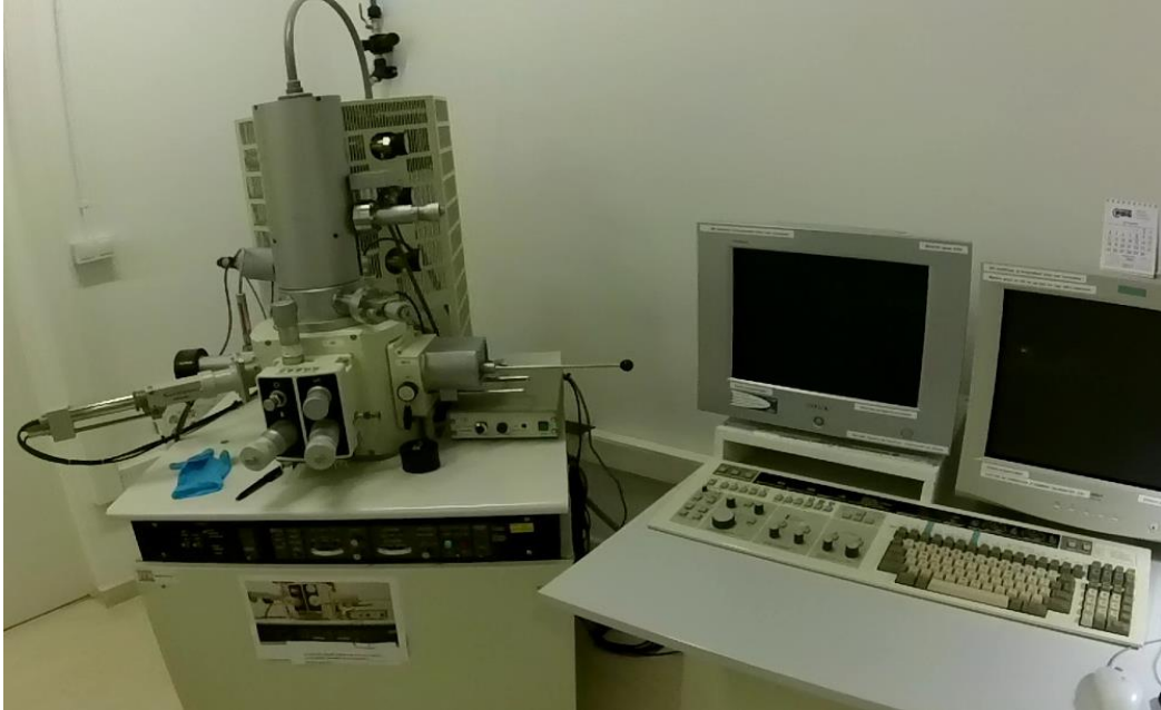
Figure II.2 : Microscope électronique à balayage type DSM Zeiss 960A (Girona, Espagne).
