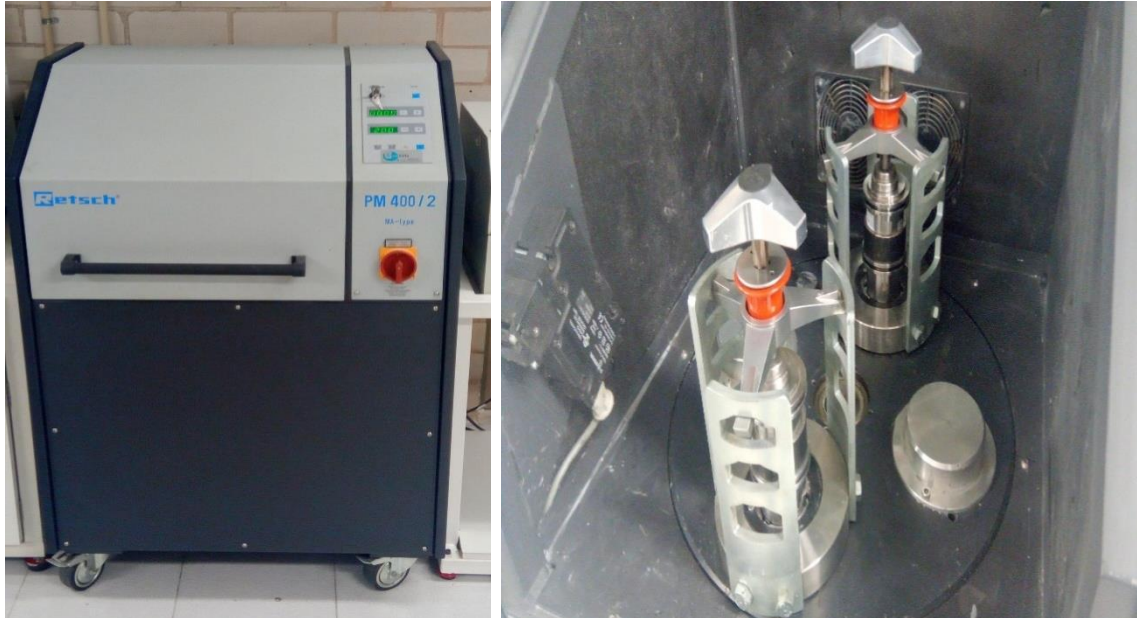
Figure II.1 : Broyeur planétaire Retsch PM400 (Girona, Espagne).
