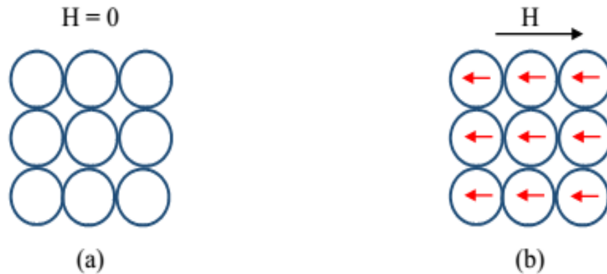
Figure I.1 : Matériau diamagnétique en l'absence (a) et en présence (b) du champ magnétique externe.
