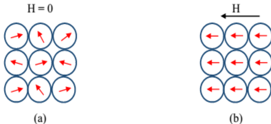
Figure I.2 : Matériau paramagnétique en l'absence (a) et en présence (b) du champ magnétique H externe.
