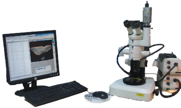
Figure 4. 1. Dispositif d'observation et de mesure utilisé pour la lecture de l'âge à l'aide du logiciel TNPC.
