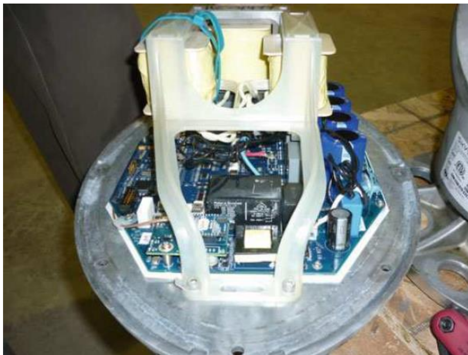
Figure I.12: Onduleur de la turbine Skystream de 2,4 kW attaché à la couverture de la nacelle [27]
