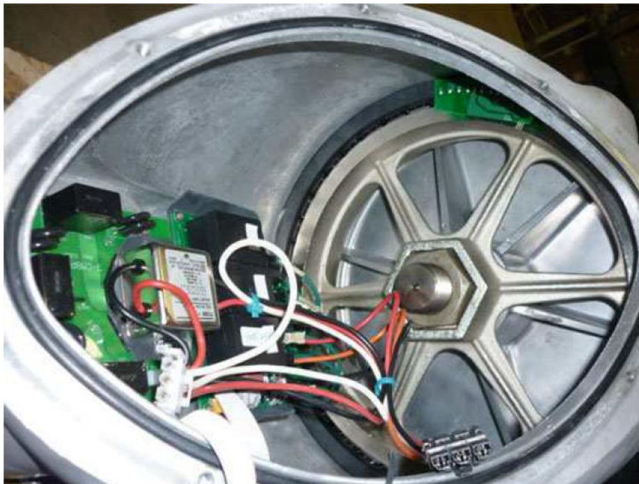
Figure I.11: À l'intérieur de la nacelle de l'éolienne Skystream 2.4 kW [27]
