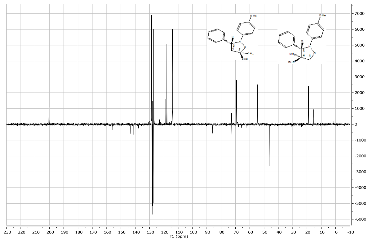
Figure III.3. Spectre de RMN de carbone 13 des composés (3,4)-endo (4a) et (3,5)-endo (5a).
