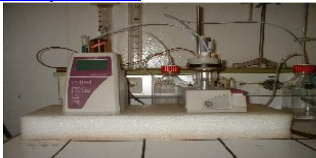
Figure (IV -29) : Photographie du dispositif pour la détermination De la teneur en eau [22]
