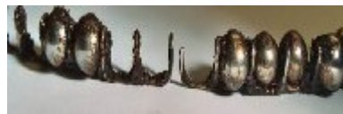
Figure (III-31) : Défaut sur la cage [19]
