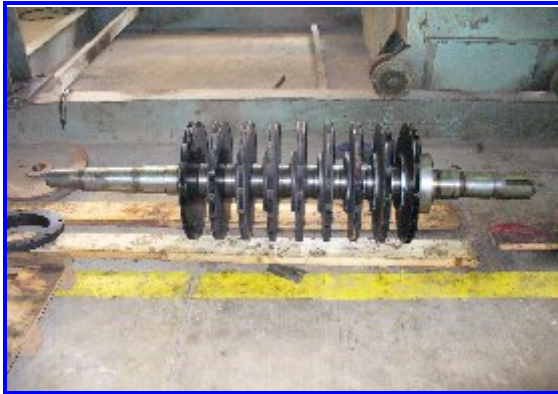
Figure (IV -3) Rotor du compresseur BP
