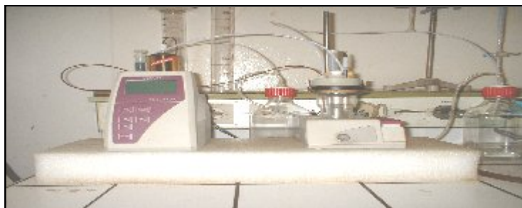
Figure (I-9) Photographie du dispositif pour la détermination de la teneur en eau[22]
