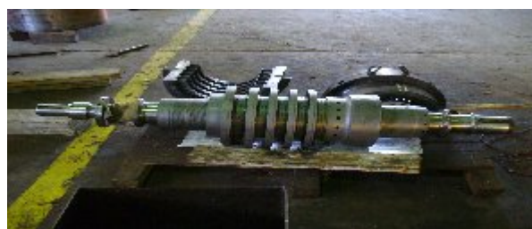
Figure (IV -25) : Rotor de la Turbine HP après équilibrage
