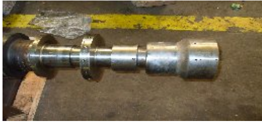
Figure (IV -26) : Palier de la turbine HP coté Rotor de la turbine BP
