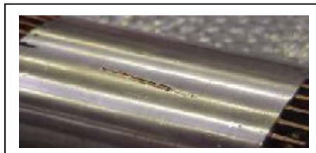
Figure (III-38) : Défaut de frottement [24]
