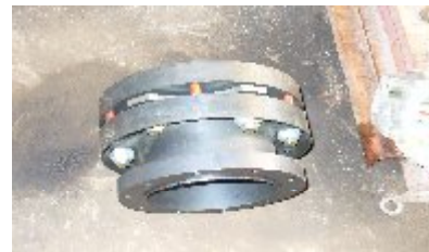
Figure (IV -24) : Accouplement Metastrem Type PSGE 3600
