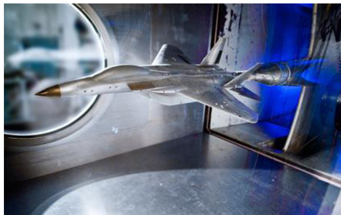
Fig 1.15. Test d'un drone dans une soufflerie
