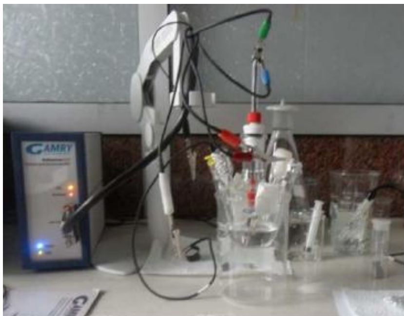
Figure III. 7: Cellule électrochimique du potentiostat (Gamry600).
