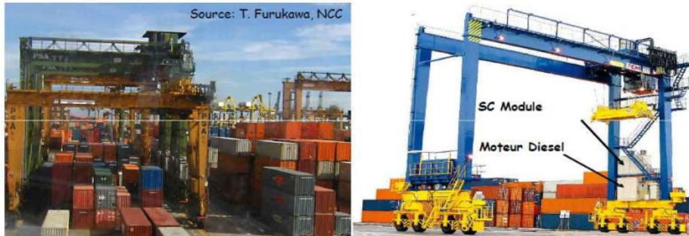
Figure I.13 : Grues aéroportuaires au Japon combinant un moteur diesel et des modules de supercondensateurs [164].
