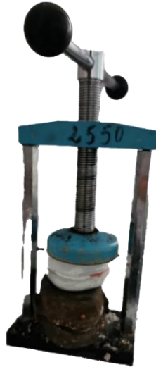
Figure n°75 : Mise en place de la boîte de duplicata sous une presse manuelle.
