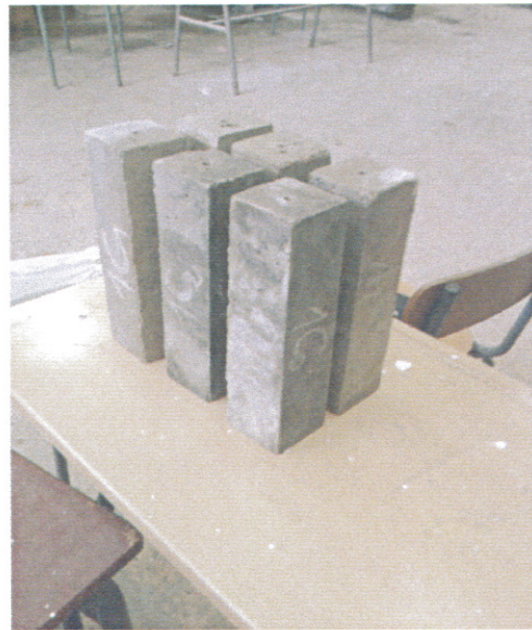
FIG II.6 : éprouvettes cylindriques 11x22 & éprouvettes prismatiques 7x7x28
