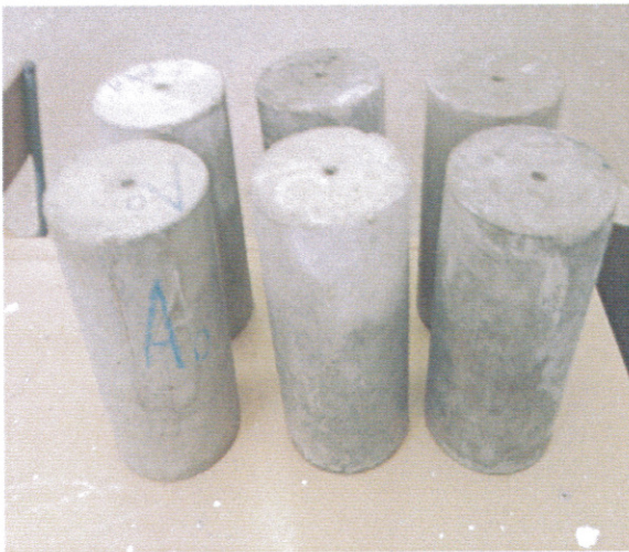
FIG II.6 : éprouvettes cylindriques 11x22 & éprouvettes prismatiques 7x7x28
