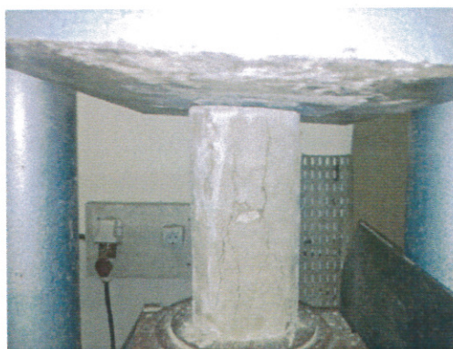
Fig III.10 : Essai de Compression sur une Eprouvette Cylindrique.
