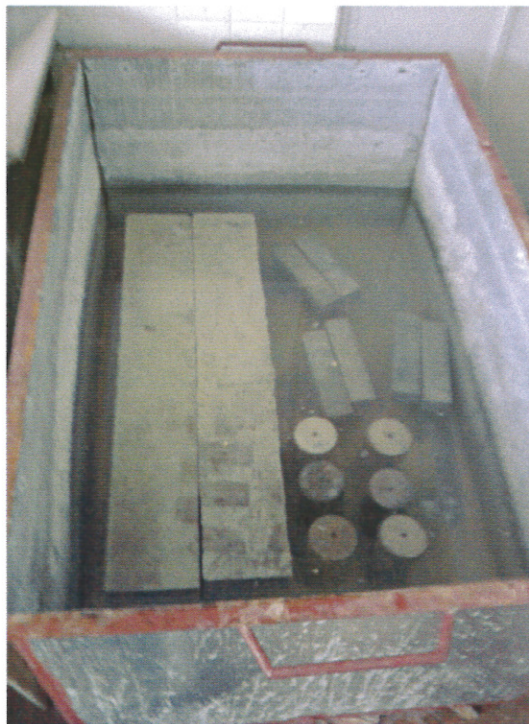
Figure. II 1. Disposition des éprouvettes dans un bac en tôle galvanisée (1,50x1,00x0,75) pour l'essai de lixiviation du béton sous l'eau de robinet et/ou l'eau de mer
