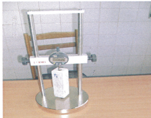
Fig. III.1 Appareil de mesure de la déformation dimensionnelle
