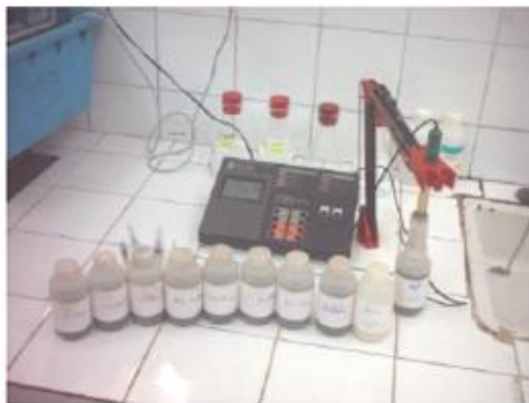
Figure 3.11 Mesure du pH (Méthode de Eades et Grim).
