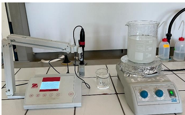
Figure 25. Ajustement du pH du MML par un pH mètre Ohaus Starter2C
