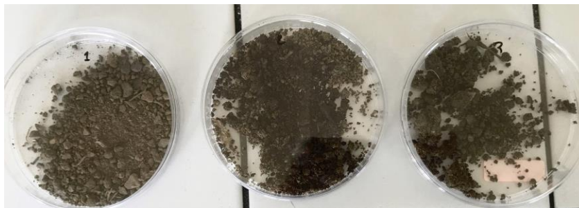
Figure 16. Echantillons de sol prélevés de la décharge de Boumehadjer (Collo)
